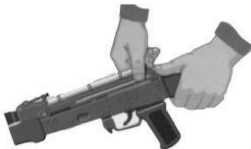
Рис. 7.14. Отделить крышку шомпол ствольной коробки
