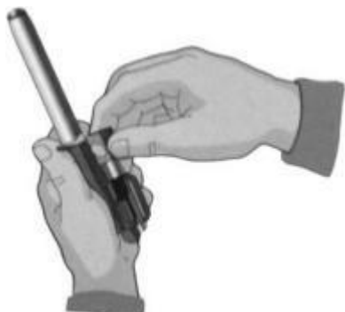
Рис. 7.16. Отделить затворную раму с затвором
