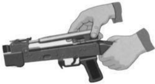
Рис. 7.16. Отделить затворную раму с затвором
