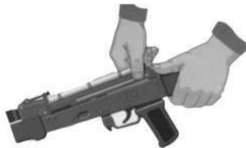
Рис. 7.14. Отделить крышку шомпол ствольной коробки
