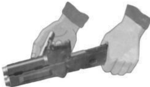
Рис. 7.17. Отделить затвор от затворной рамы
