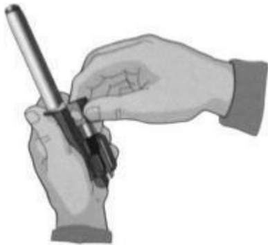
Рис. 7.16. Отделить затворную раму с затвором
