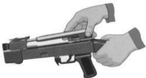
Рис. 7.16. Отделить затворную раму с затвором
