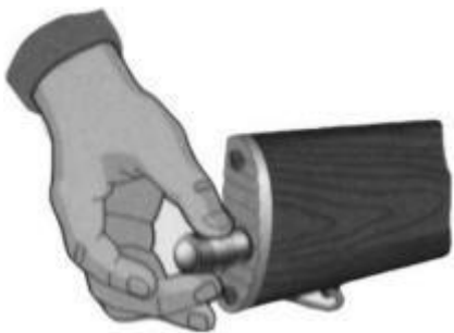
Рис. 7.12. Вынуть пенал с принадлежностью
