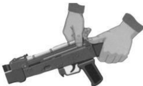
Рис. 7.14. Отделить крышку шомпол ствольной коробки
