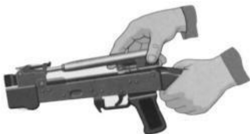
Рис. 7.16. Отделить затворную раму с затвором
