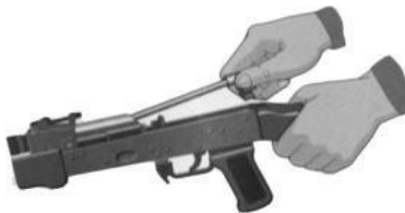
Рис. 7.15. Отделить возвратный механизм
