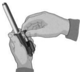
Рис. 7.17. Отделить затвор от затворной рамы
