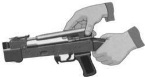
Рис. 7.16. Отделить затворную раму с затвором
