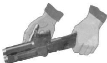
Рис. 7.18. Отделить газовую трубку со ствольной накладкой
