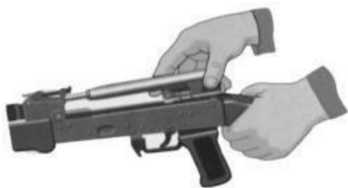
Рис. 7.16. Отделить затворную раму с затвором
