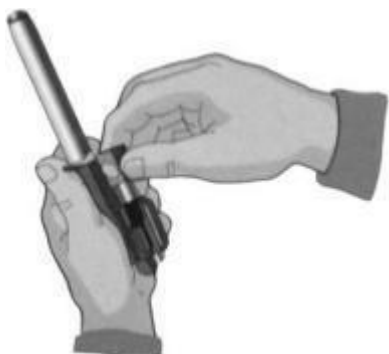
Рис. 7.16. Отделить затворную раму с затвором
