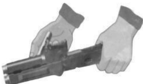
Рис. 7.17. Отделить затвор от затворной рамы
