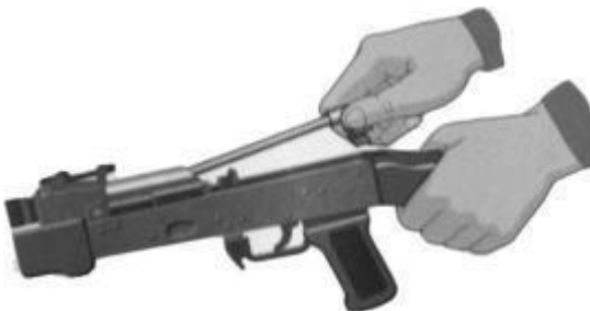
Рис. 7.14. Отделить крышку шомпол ствольной коробки
